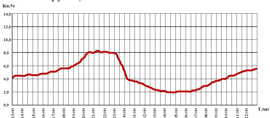
Рис. 1 Коэффициент искажения синусоидальной кривой напряжения.
