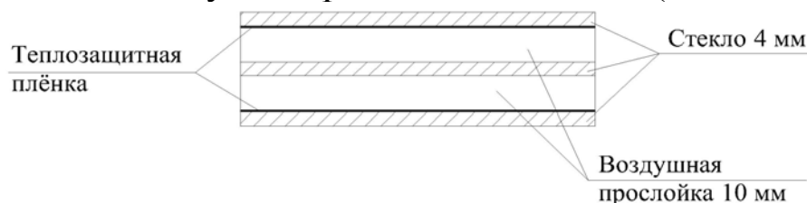
Рис. 4. Схема двухкамерного стеклопакета (4–10–4–10–4)
